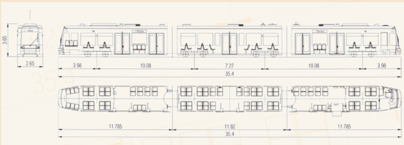
Straßenbahntriebwagen Typ Flexity Classic (Bombardier Transportation). Betreiber: Bremer Straßenbahn AG (BSAG), Länge: 35,40 m, Breite: 2,65 m, Höchstgeschwindigkeit: 70 km/h, kleinster befahrbarer Bogenhalbmesser: 23 m, maximale Steigung: 45‰, Niederfluranteil: 74%, Sitzplätze: 106, Stehplätze: 135 (4 pass/m 2 ), Niederflorausführung: Fußbodenhöhe 30 cm über Schienenoberkante am Eingang, Leistung: 4*125 kW, Gewicht: 48 t (leer), 74 t (beladen).
