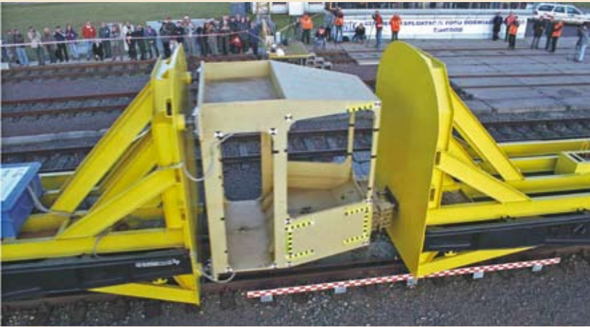
Crashversuch mit der Safetram-Citytram auf dem Versuchsgelände Zmigrod in Polen 2004.
